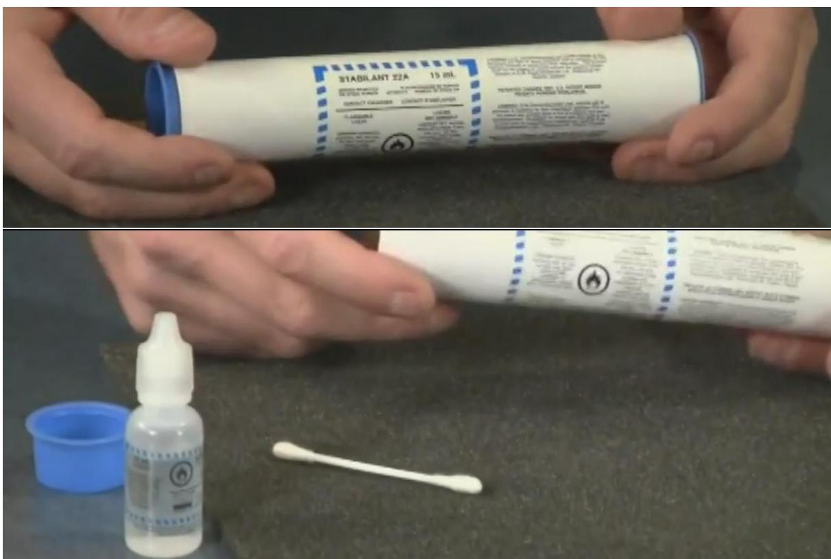
Koristi se na ivicama RAM modula, na zlatnim kontaktima ili na slotovima na matičnoj ploči posebno ako se primeti bilo kakva korozija čime se povećava protok struje na kontaktima.
