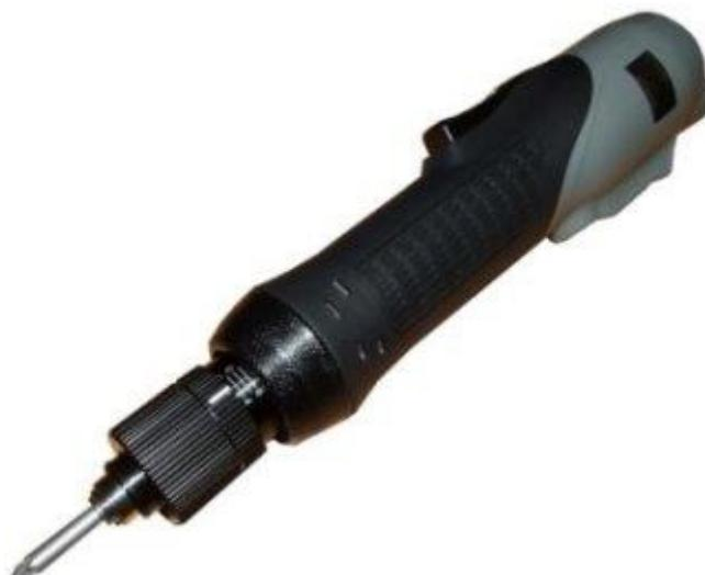
Ovi šrafcigeri dolaze sa lako promenjivim vrhom. Na mnogima je moguće regulisati broj obrtaja pa se može podesiti da ne zavrću šraf sve do pucanja podloge već samo dok se ne oseti otpor podloge. Na taj način se neće oštetiti plastična podloga kućišta na kojoj treba pričvrstiti šraf.
