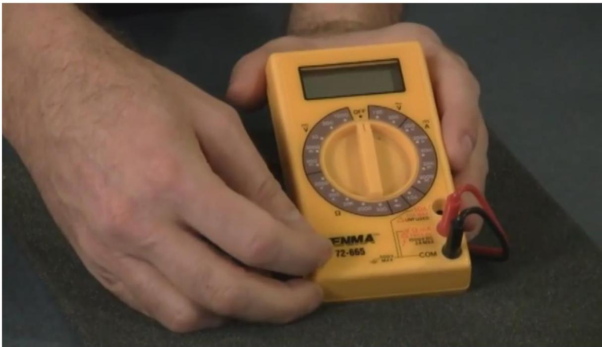
Koristi se za proveru napona i otpornosti na izlazu kutije za napajanje. Može da posluži za proveru izlaznog napona iz kutije za napajanje i da li ona odgovara naponskom nivou koji je garantovan od strane proizvođača.
