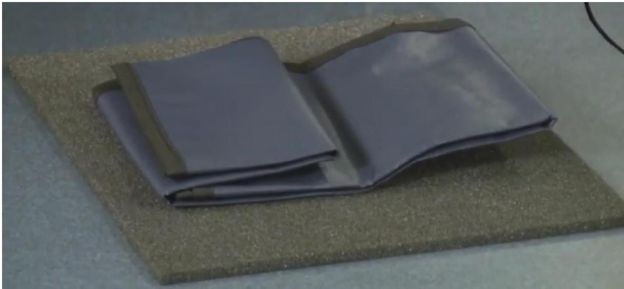
Veliki problem za računar je ESD-Electro Static Discharge (elektrostatičko pražnjenje), svaka komponenta koja se izvadi iz kućista se prvo stavi na ovu podlogu. Ponaša se kao slabi provodnik. Ona omogućava da sve što je dodirne bude na istom elektrostatičkom potencijalu da ne bi došlo do protoka elektriciteta prema komponentama.
