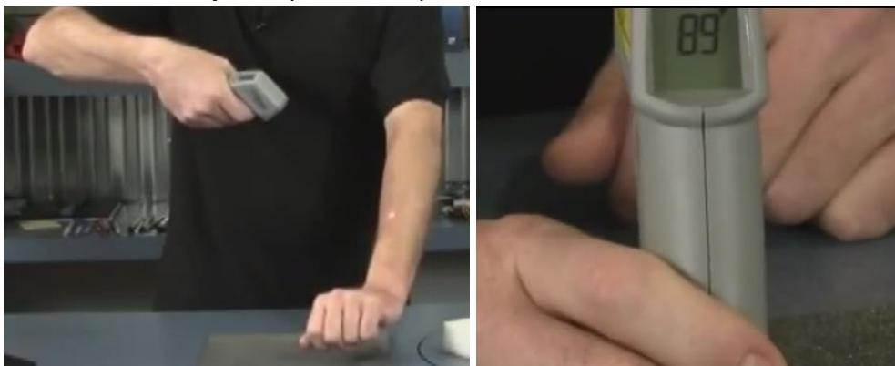
Često se dešava da kada čip na matičnoj ploči počne da otkazuje, njegova radna temperatura se povećava. Ovaj termometar se uperi na čip pritisne se dugme nekoliko sekundi i može seочitati temperatura koja će ostati zapamćena oko 10 sekundi.
