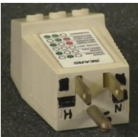
Koristi se za proveru napona u štekeru odakle dolazi napon prema kućištu. Ako nije dobro izvedeno napajanje iz zidnih instalacija, na računaru se javlja nekontrolisan statički elektricitet koji može izazvati pražnjenje i oštećenje opreme ili povrede servisera opreme.
