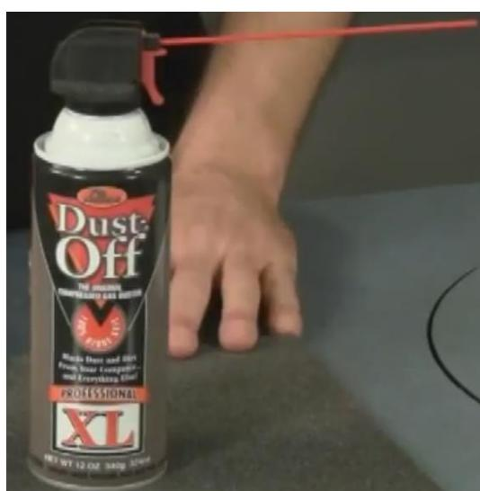
Koristi se najčešće za otklanjanje malih količina prljavštine ili prašine na računarskim komponentama (tastatura). Treba voditi računa da se ne pretera sa revnosnošću čišćenja prašine i nečistoća jer se ponekad dešava suprotan efekat što nije dobro po računarsku opremu.
